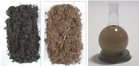
Abbildung 3: Entfärbung von Xylit durch eine intensive Bewässerung und Färbung des aufgefangenen Drainwassers (Foto: HSWT)
