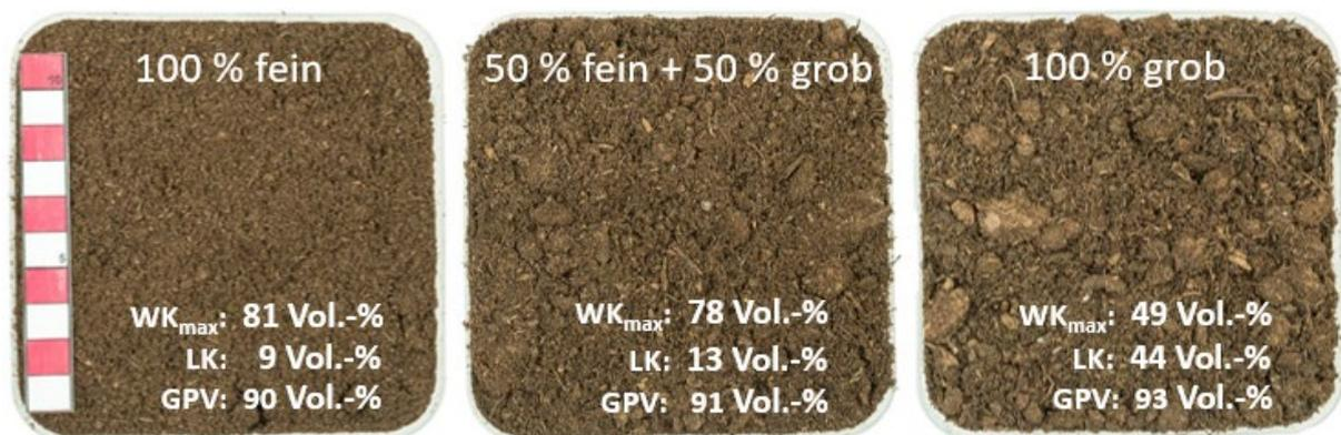
Abbildung 1: maximale Wasserkapazität ( $WK_{max}$ ), Luftkapazität (LK) bei  $WK_{max}$  und Gesamtporenvolumen (GPV) eines Sodentorfes in Abhängigkeit von der Struktur<sup>3</sup>
