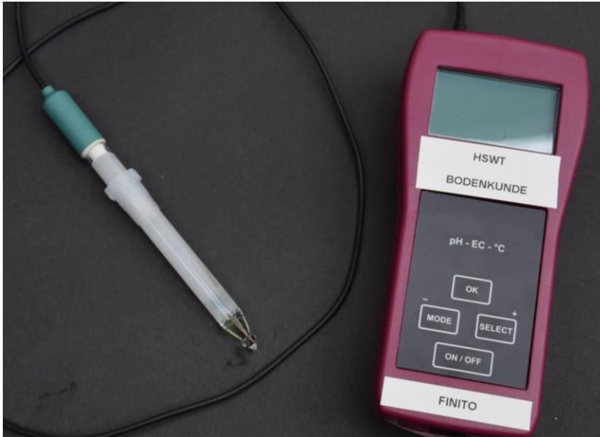
Abbildung 1: pH-Messgerät mit Einstichglaselektrode
